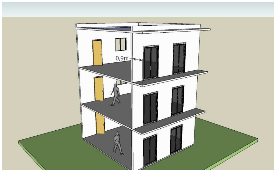
FIGURA A3 – MODELO DE COMPARTIMENTAÇÃO VERTICAL (ABAS)
